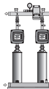
Druckerhöhungsanlagen mit zwei Pumpen mit variabler Drehzahl (Frequenzumrichter EASYMAT)
