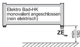
Elektro-Heizstab alternativ rechts oder links montierbar
