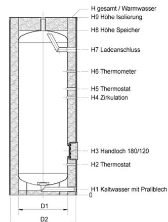
• **Warmwasseranschluß oben**
