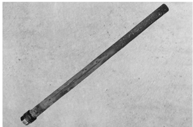
Abb. 65: Magnesium-Schutzanode, Länge 480 mm, Ø 26 mm
